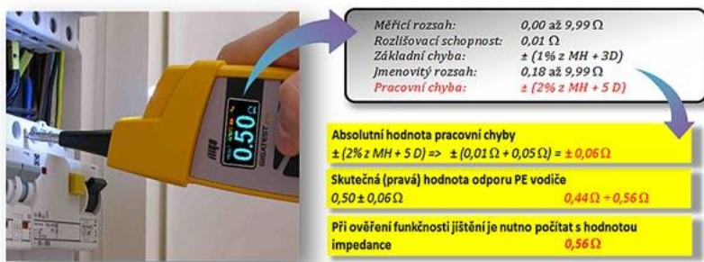
Obr. 7 – Postup při stanovení maximální možné impedance zjištěné měřením
