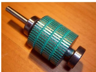
Obr. 6: Detail umístění cívek statoru a jejich pólů. Jsou zde patrné jednotlivé „zuby“
