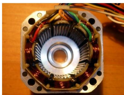
Obr. 7: Detail rotoru krokového motoru. Na obrázku je patrné umístění a vzájemné posunutí permanentních magnetů
