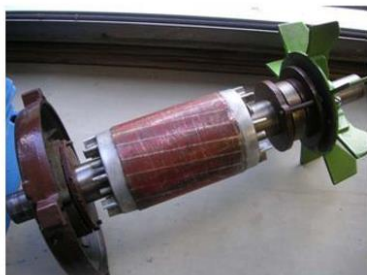
Obr. 5: Kotva nakrátko s ložisky a větrákem
